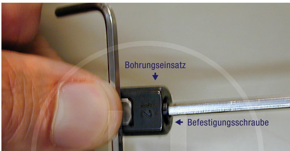
Ausrichten des Bohrungseinsatzes mit einfachsten Hilfsmitteln.
