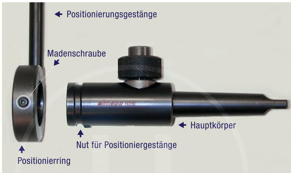
Die Madenschraube wird erst fest angezogen, wenn das Werkzeug in der Standbohrmaschine ausgerichtet ist.
